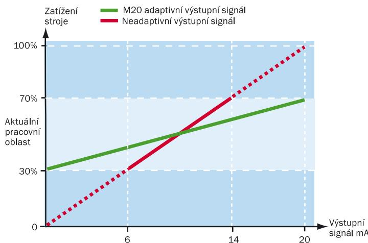
M20 má vysokou přesnost také při velmi malých odchylkách zatížení. Výstupní analogový signál lze využít jako měřítka zatížení stroje v aktuálním pracovním rozsahu.
