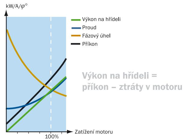
Výpočet výkonu na hřídeli umožňuje spolehlivější kontrolu než nelineární metody. Měření proudu je dostatečné pouze při vysokých zatíženích motoru a fázový úhel pouze při nízkých zatíženích. Příkon je lineární, ale ignoruje ztráty v motoru.
