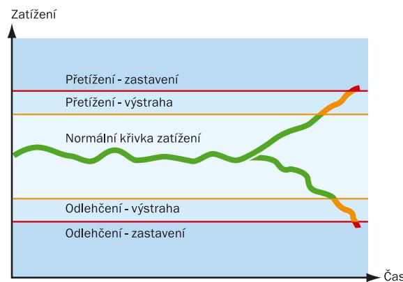
Hlídac zatížení M20 chrání vaše zařízení a výrobní proces před poškozením a prostoji. Včasné varování a zastavení umožňují přijmout preventivní opatření.
