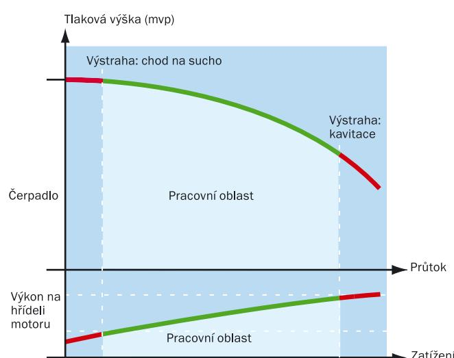
tak, že je monitorován výkon na hřídeli motoru. Výsledkem je okamžitá výstraha nebo zastavení v případě, že čerpadlu hrozí riziko chodu na sucho nebo kavitace. Tato metoda je přímo úměrná ke křivce čerpadla.
