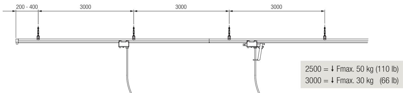
Installationen mit Werkzeugträgerwagen, Gerätewagen usw., max. Abhängedistanz 2000 mm
