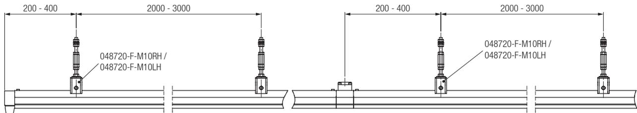
Pro Schienenstrang wird nur ein Festpunktaufhänger (rot) 048720-F-M10RH oder 048720-F-M10LH benötigt. Der Festpunktaufhänger sollte immer nahe der/einer Luftpfeisung (z.B. Axialeinspeisung 048730-06 oder Einspeiseverbinder 048731-05) befestigt werden.
