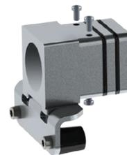
**Axialeinspeisung:** Für die Anschlussstücke sind entweder zylindrische Rohrgewinde G (DIN EN ISO 228-1) mit Flachdichtung oder konische R-Gewinde (ISO 7-1) zu verwenden, welche fachgerecht abgedichtet werden. NPT-Gewinde dürfen nicht verwendet werden.
