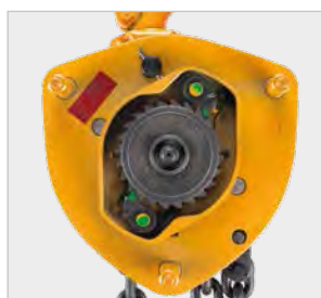
Dvě brzdové západky se zdvojenými pružinami pro vyšší bezpečnost
